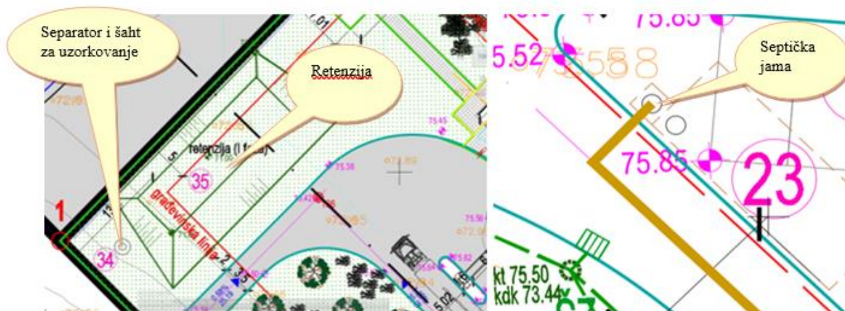
Slika 3.1. Retenzija, separator, šaht za uzorkovanje i septička jama
